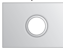
Прессование - фланцевое отверстие
